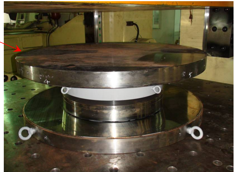
ASBD隔震系統支承墊在國家地震中心試驗現況
