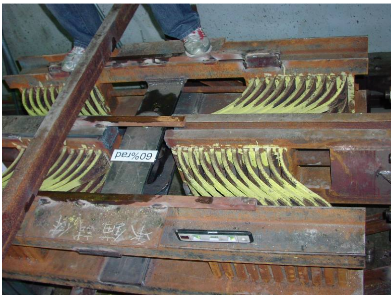
台大地震中心75噸/40cm性能試驗
