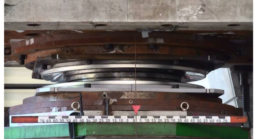
ASBD隔震系統支承墊在國家地震中心試驗現況
