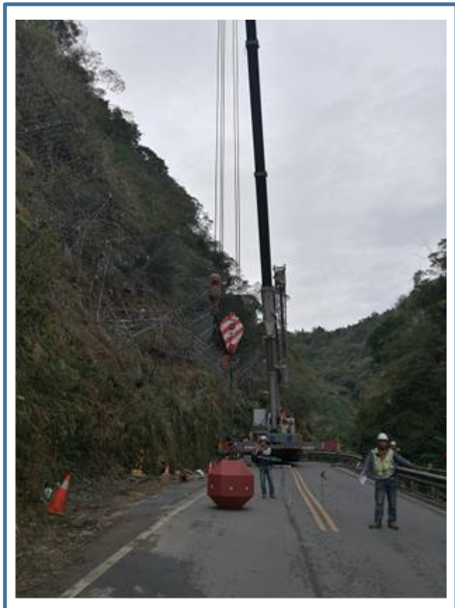
照片 2 模擬落石的球體
