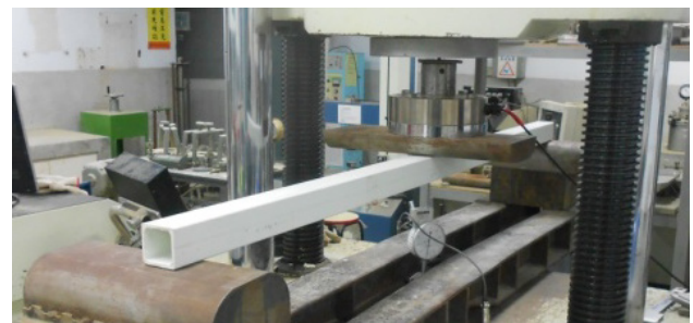
圖 5 GFRP 構件三點抗彎實驗過程圖
